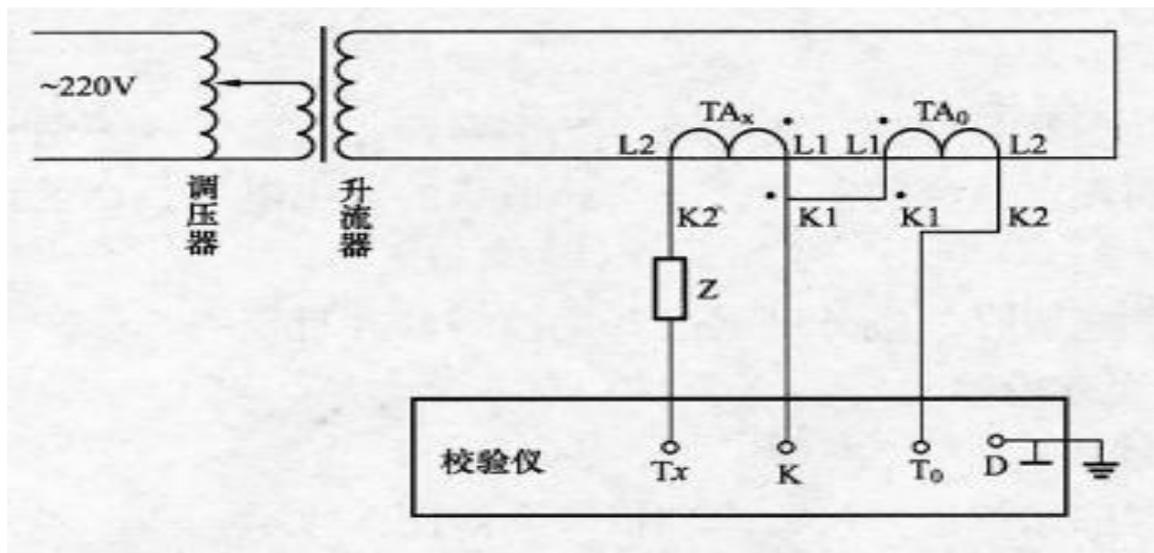
4. 误差检验点：在额定负载，检验额定一次电流的 1% (S 级)，5%，20%，100%，120% 点的误差；在下限负载，检验额定一次电流的 1% (S 级)、5%，20%，100% 点的误差。
